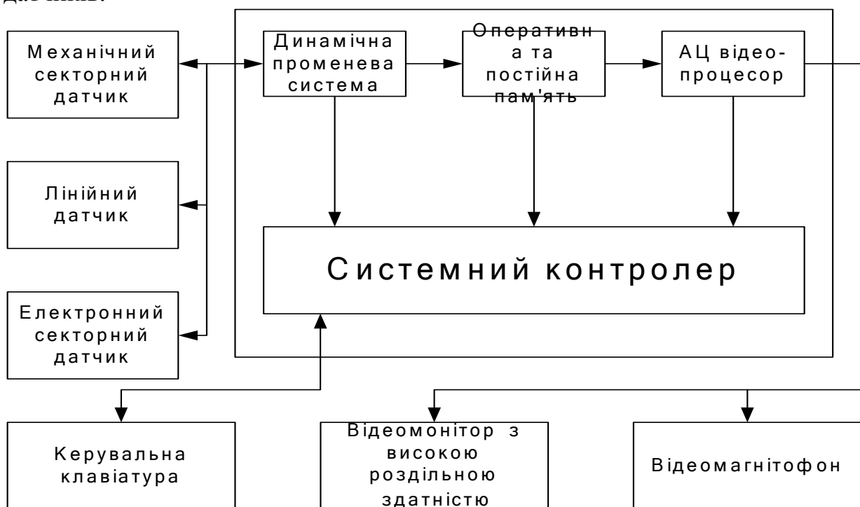
Рисунок 2.21 – Структурна схема типового ультразвукового діагностичного пристрою
