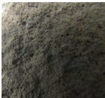
Рис.4 Структура пінобетону, виготовленого на основі сухих будівельних сумішей та СДО у якості піноутворюючої добавки
