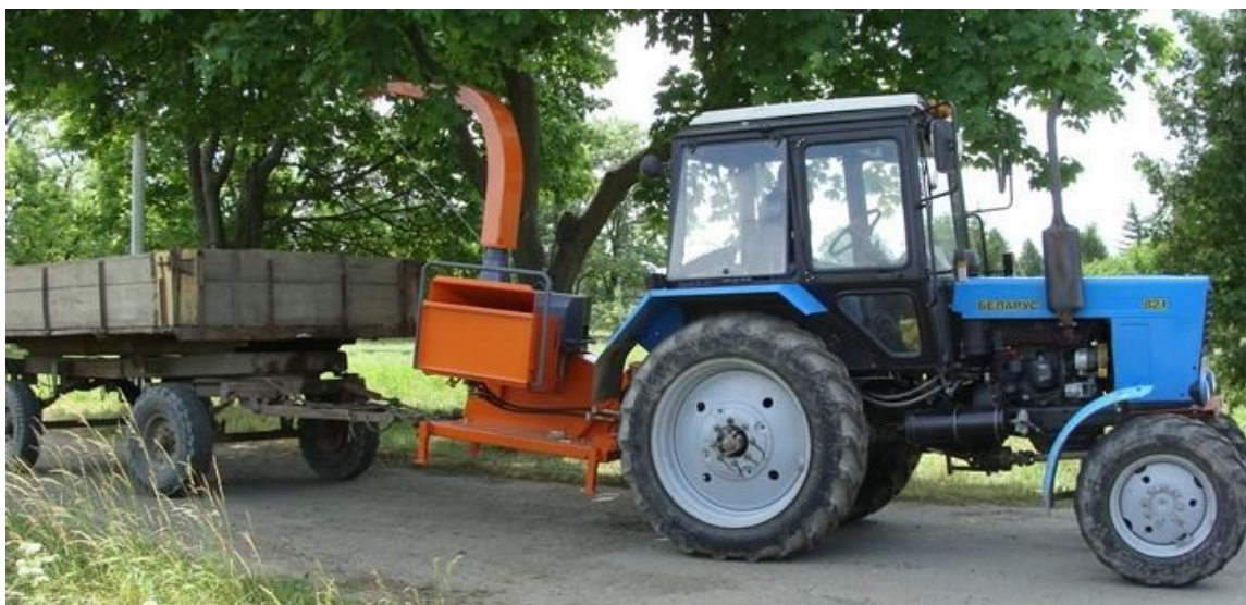
Рисунок 1 – Зовнішній вигляд подрібнювача RM 800.5 приєднаного до трактора
