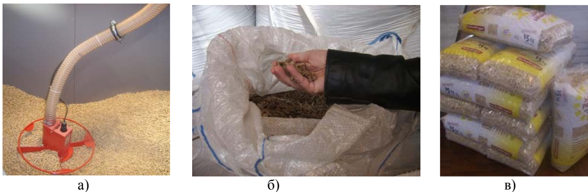
Рисунок 5 – Розфасовка пелет насипом а), у біг-беги б) та дрібно в)
