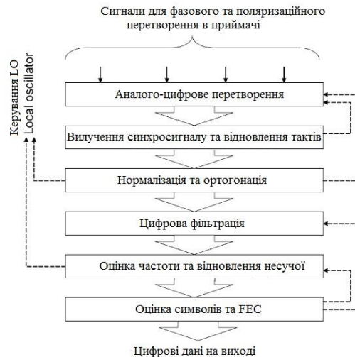
Рисунок 3 – Алгоритм цифрового оброблення інформаційних сигналів в оптичному приймачі когерентних ВОСП
