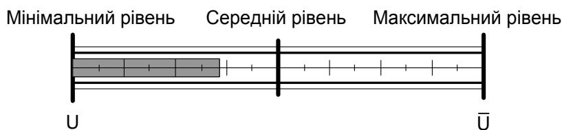
Рис. 1. Оцінка параметра за принципом термометра
