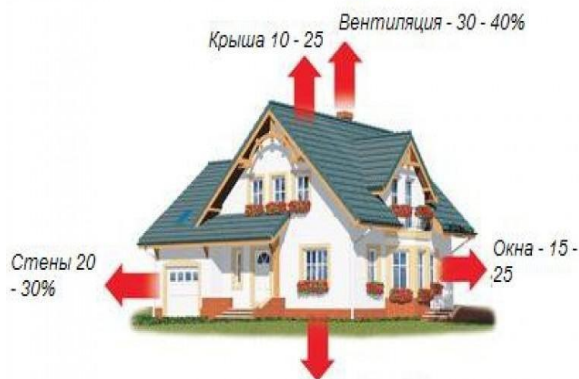
Рис. 1– Орієнтовний розподіл втрат тепла в одноповерховому будинку (за даними Лапіна Ю. М.[5], б – за даними Блазі В. [9]; в – за даними [10])
