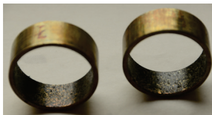
Рисунок 7 – Втулки из материала БФГ-50М после испытаний на устойчивость при циклическом изменении температур
