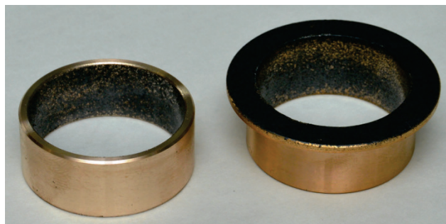
Рисунок 4 – Спеченные втулки из материала БФГ-50М (слева – без фланца; справа – с фланцем)
