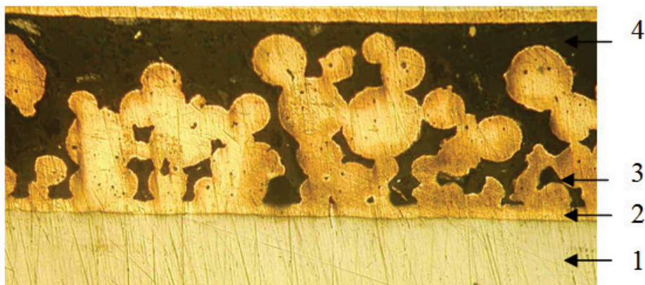
1 – стальная основа; 2 – медный подслой; 3 – пористый слой из сферических частиц бронзы; 4 – антифрикционный слой на основе фторопласта (x 100)
