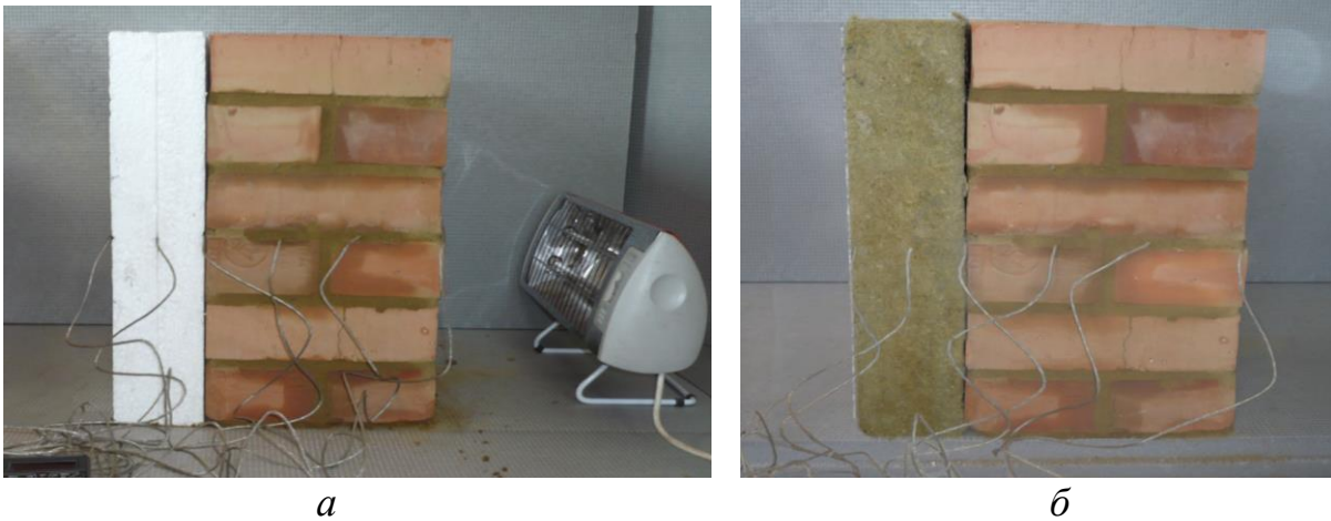
Рис. 5. Загальний вигляд досліджуваної конструкції з зовнішніми утеплювачами: а – пінопласт, б – мінеральна вата
