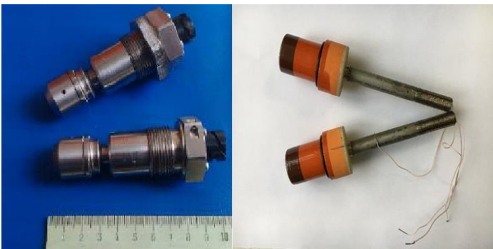
Рисунок 4 – Електроакустичні перетворювачі типу ПЭА-114 і ПЭА-103
