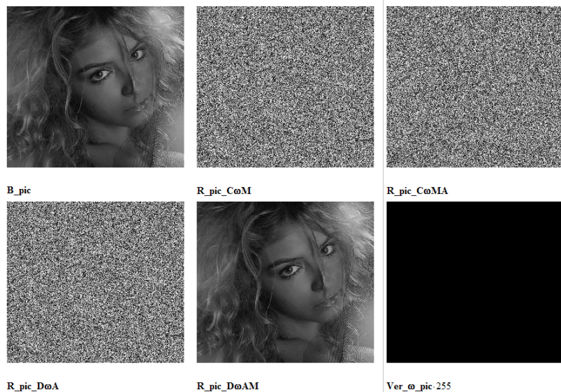
Рис. 8. Результати прямого та оберненого КП МАШ B складової кольорового зображення в разі використання для мультиплікативної та адитивної складових МАШ лише одного МК Key_Cw_R(5).
