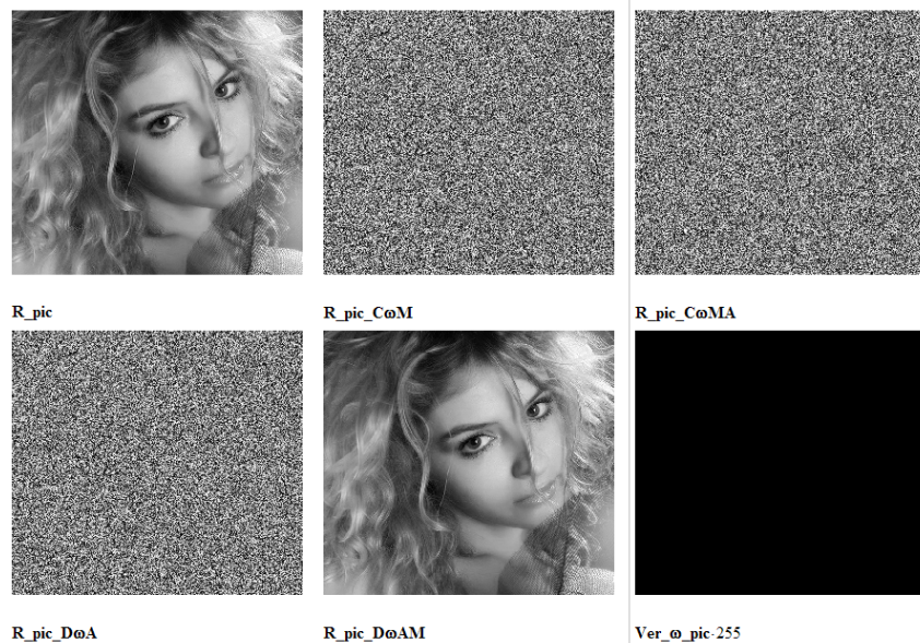
Рис. 6. Результати прямого й оберненого КП МАШ R складової кольорового зображення в разі використання для мультиплікативної та адитивної складових МАШ лише одного МК Key\_Cw\_R(2) .
