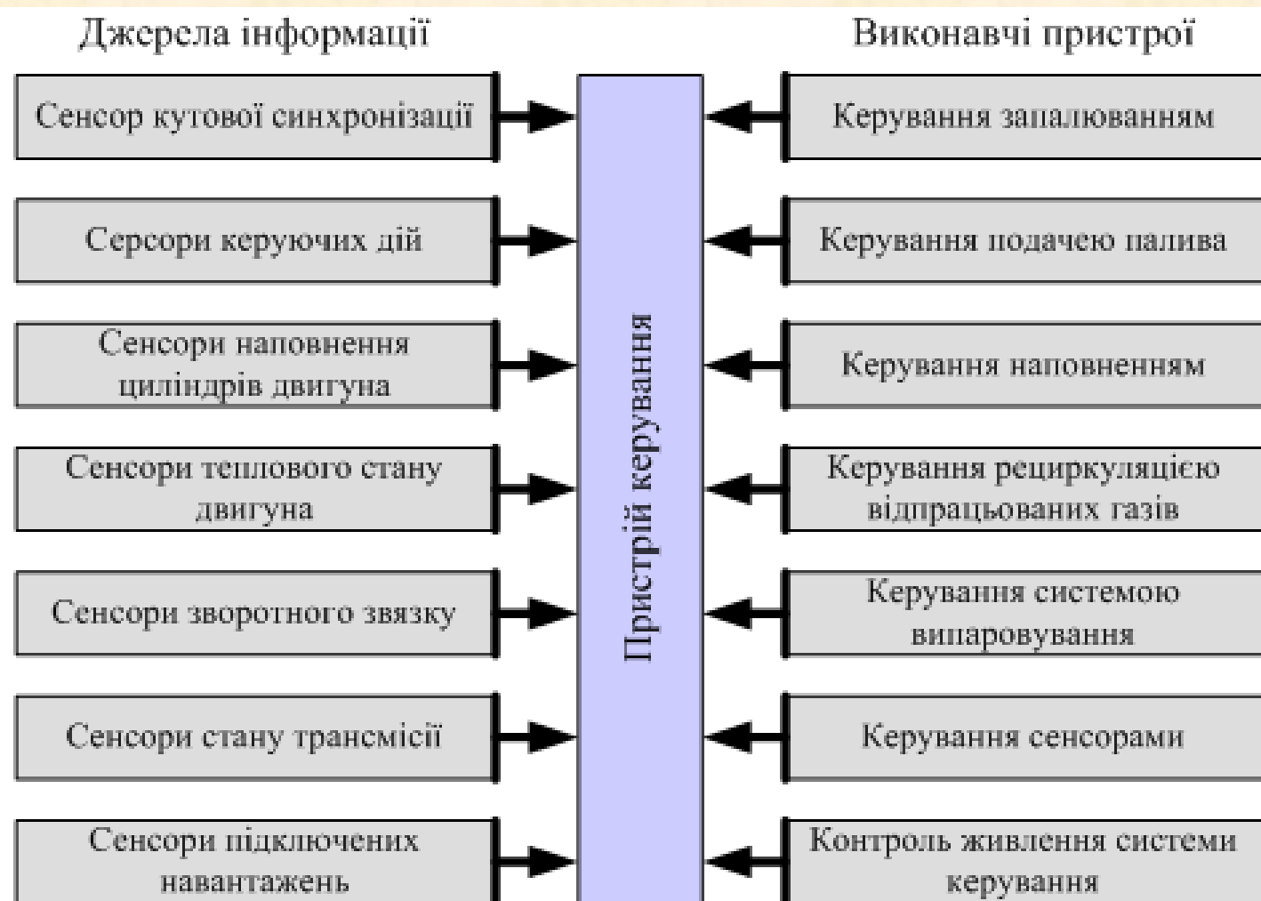
Рисунок 1 – Структурна схема управління робочим процесом автомобільного двигуна
