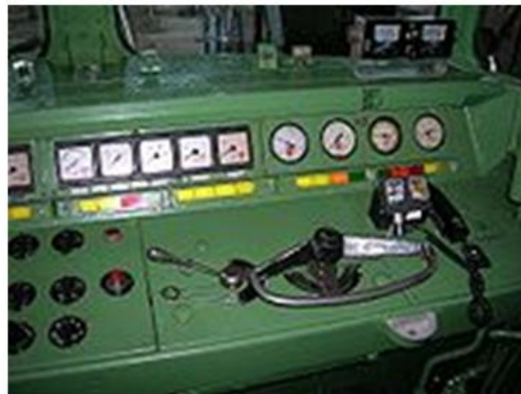
Рисунок 2 – Пульт керування керування електровоза ЧС-4
