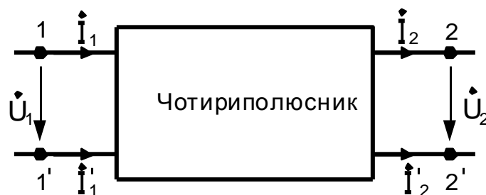
Рисунок 3.8 – Подання біполярного транзистора у вигляді лінійного чотириполюсника
