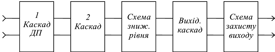
Рисунок 11.4 – Типова структурна схема операційного підсилювача
