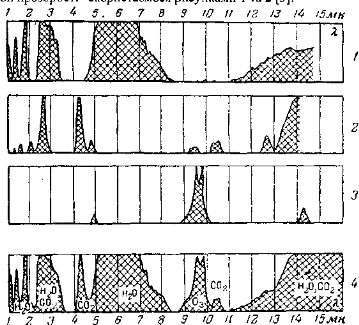
Рис. 1. Смуги поглинання випромінювання основними компонентами атмосфери: 1 – пари води, 2 – вуглекислий газ, 3 – озон, 4 – сумарна картина
