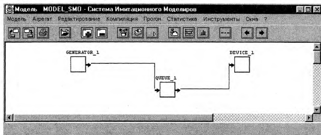
Рис. 1. Агрегатна модель найпростішої СМО
