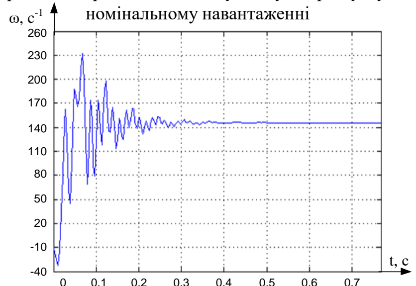
Перехідний процес по кутовій швидкості двигуна при пуску на номінальному навантаженні
