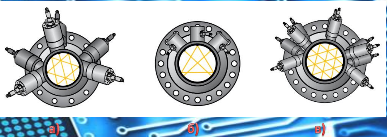
Рисунок 4 – Схема розташування вимірювальних каналів в Q.Sonic: а) Q.Sonic-3; б) Q.Sonic-4; в) Q.Sonic-5
