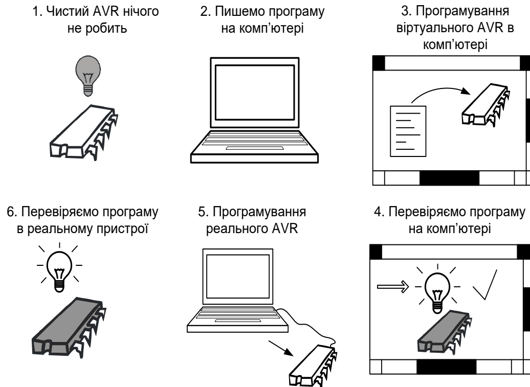
Рисунок 1 – Етапи розробки програмного забезпечення мікроконтролерів AVR
