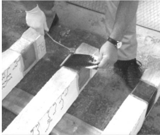
Рис. 3. Підсилення дослідного зразка стрічкою Sika CarboDur S-512 по нормальним перерізам
