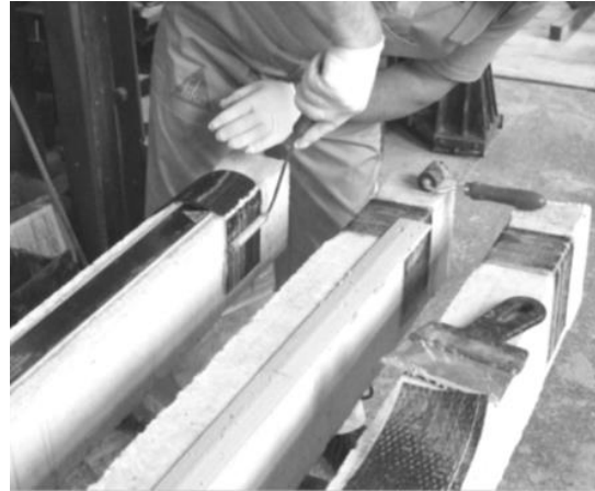
Рис. 3. Підсилення дослідного зразка стрічкою Sika CarboDur S-512 по нормальним перерізам
