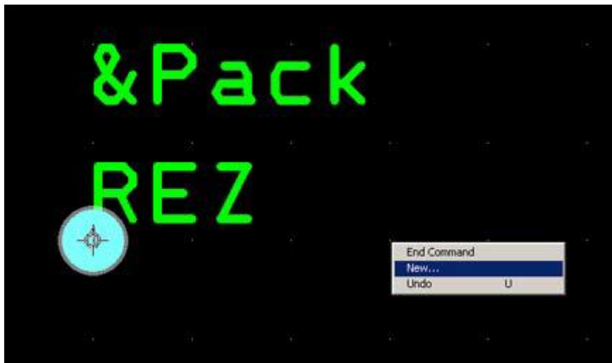
Рисунок 3.3 – Встановлення нового виводу
