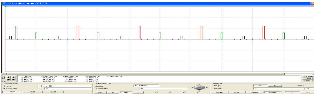
Керуючі імпульси, відповідні кутку управління в 67.50^\circ (задає двійковий цифровий код - 10)
