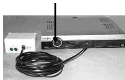
ИК-адаптер «Цифрового телесканера» для управления тюнером от ПК
