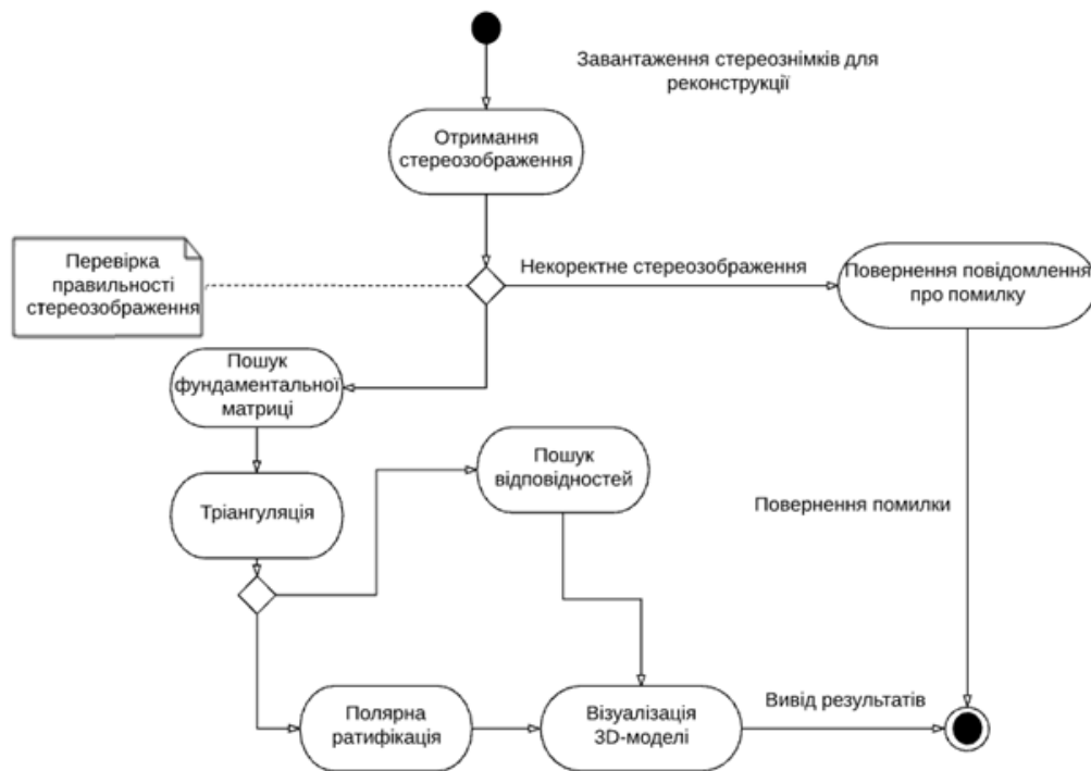
Рис. 1 – UML-діаграма програмного модулю реконструкції 3D-моделей
