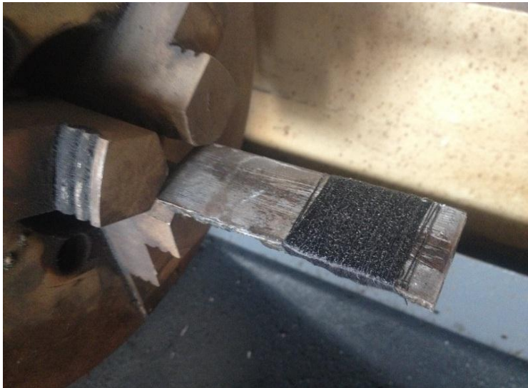
Віскозна нитка, нанесена на поверхню
