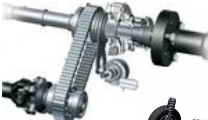
Рисунок 1 - Схема реалізації повного приводу на автомобілі BMW X5
