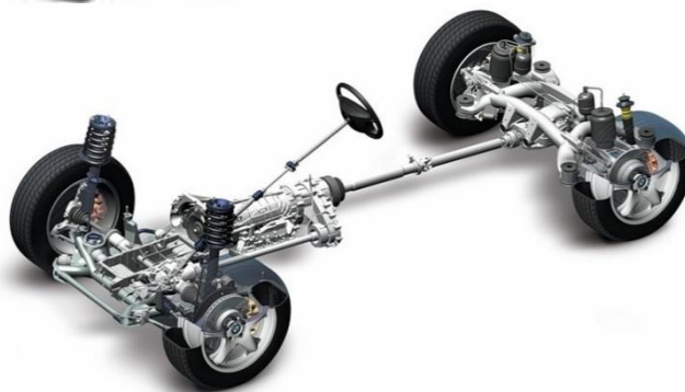
Рисунок 1 - Схема реалізації повного приводу на автомобілі BMW X5
