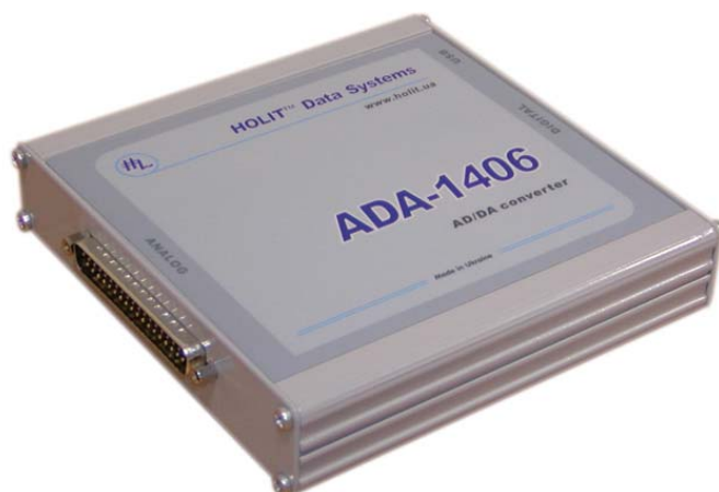
Рисунок 1.7 – Загальний вигляд перетворювача ADA-1406
