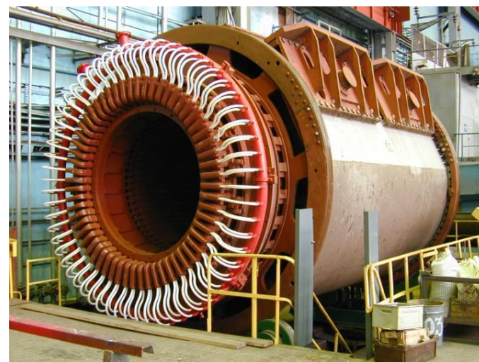
Рисунок – Турбогенератор серії TBB
