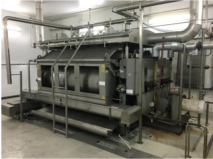
Зовнішній вигляд розпилювальної сушильної установки «Blow – Клох»
