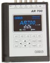
Переносний прилад марки «AR 700» для аналізу акустичних сигналів
