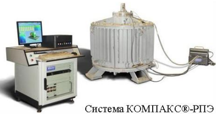
Вимірвальні комплекси для діагностування електричних машин за спектром струму
