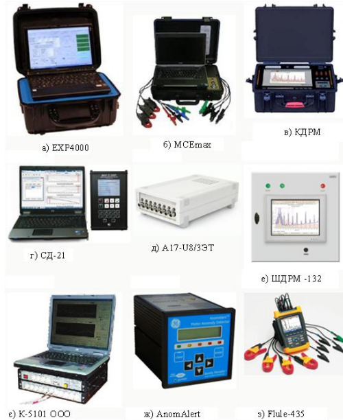
Вимірвальні комплекси для діагностування електричних машин за спектром струму
