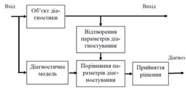
Узагальнений алгоритм технічного діагностування електромоторів
