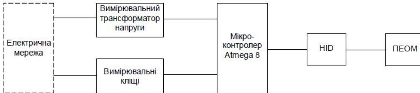
Структурна схема пристрою для вимірювання показників якості електричної енергії
