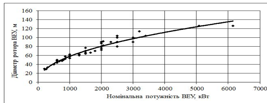
Рисунок 9.2 – Залежність діаметра ротора від потужності ВЕУ
