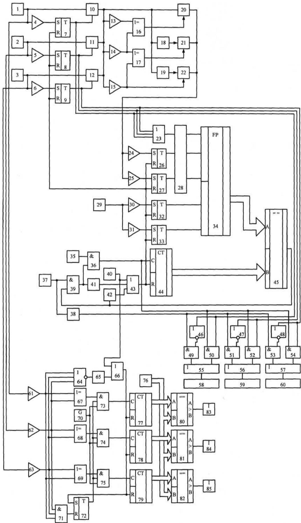
Корисна модель належить до галузі електротехніки і може бути використана для вимірювання комутаційного ресурсу повітряних високовольтних вимикачів.
