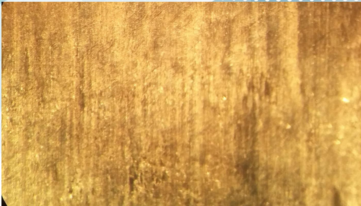
Рисунок 3 - Макроструктура сормайтового після випробування
