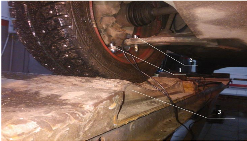
1 - вібродатчик №1; 2 - вібродатчик №2; 3 – платформа люфт-детектора
