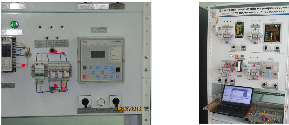
Рис.1. Зовнішній вигляд лабораторного стенду для дослідження параметрів мікропроцесорного захисту та протиаварійної автоматики
