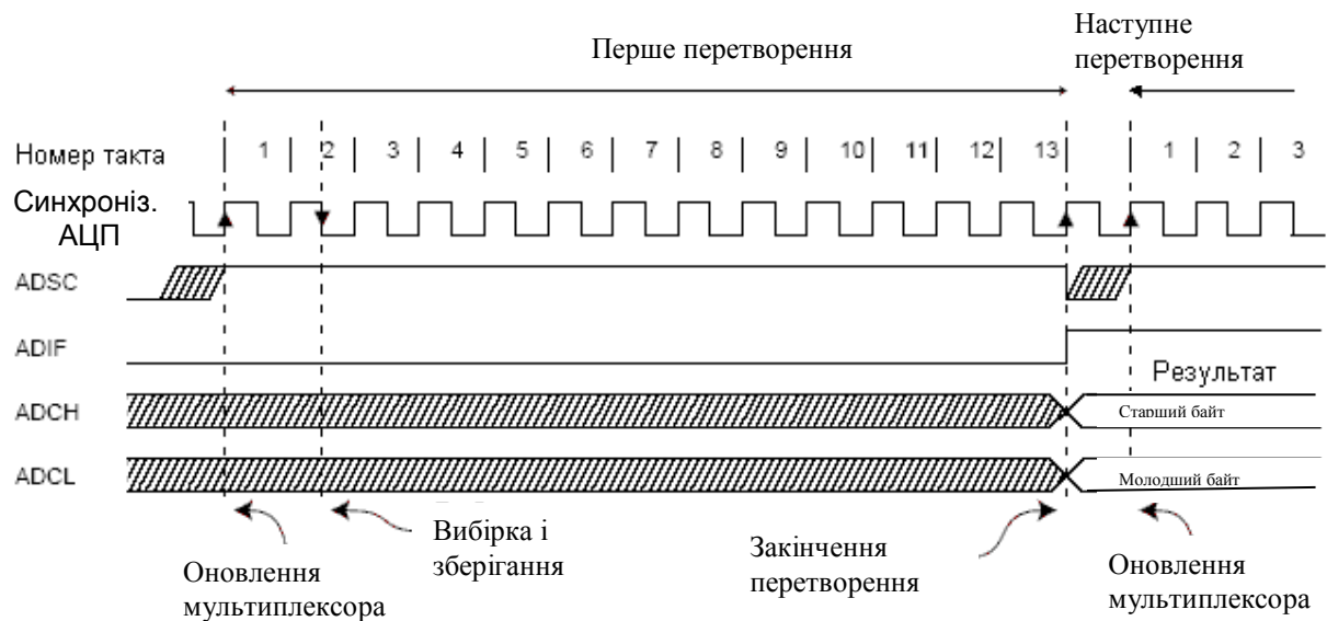
Рисунок 12.3 – Часова діаграма роботи АЦП при одиничному перетворенні
