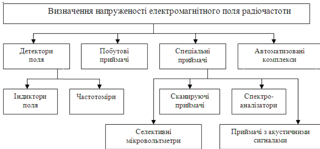
Рис. 1. Класифікація засобів контролю електромагнітного поля Функціональна схема датчика складається з основних блоків:
