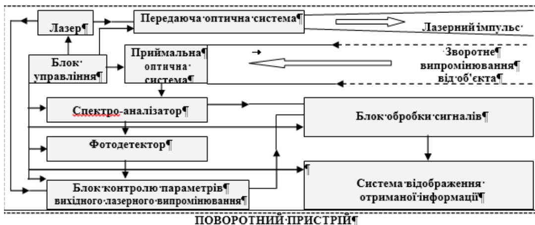
Рис. 1. Загальна структурна схема лідарної системи
