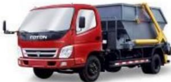
Рис. 3. Вантажівка із гачковим автоматом підйому для контейнерів об'ємом 8 м 3 для збирання великогабаритних відходів
