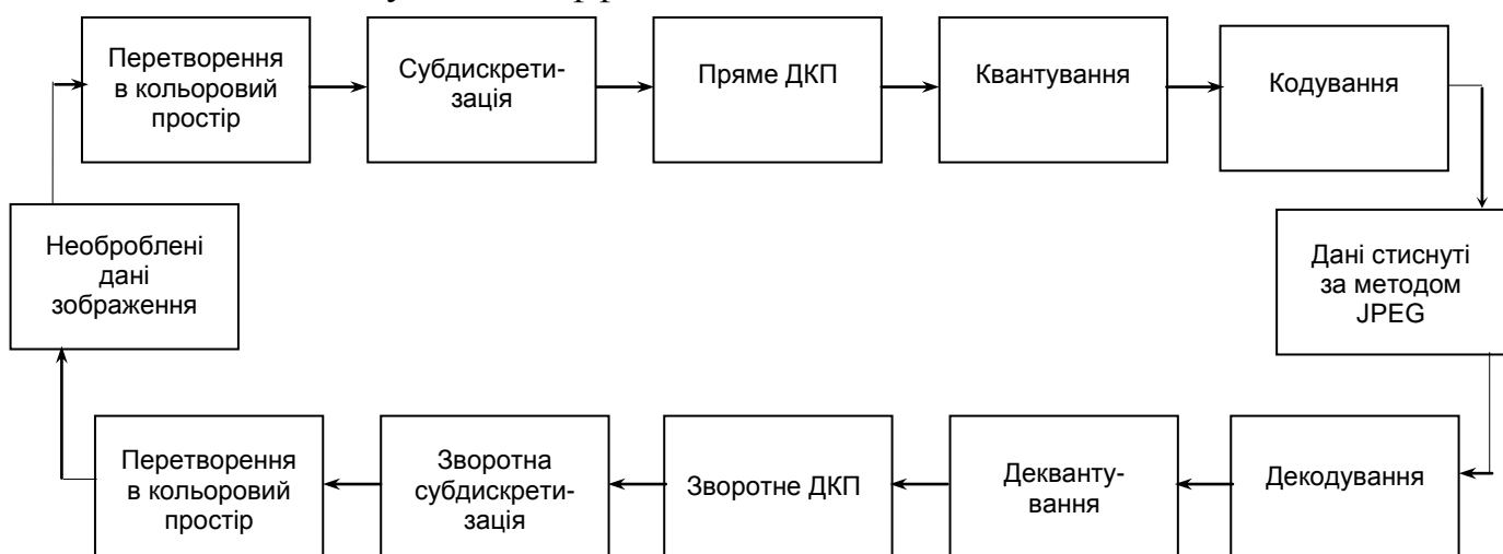
Рисунок 3.1-Послідовність операцій при стисненні зображень за методом JPEG
