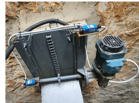
Шибер (приводний двигун, кінцеві перемикачі)
