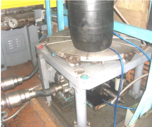
Рисунок 12 – Фото експериментального зразка віброустановки для просторового вібраційного навантаження
