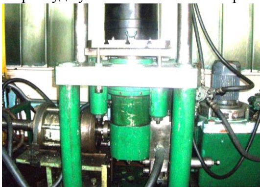
Рисунок 8 – Фото експериментальної віброустановки з одновісним накладанням вібрації
