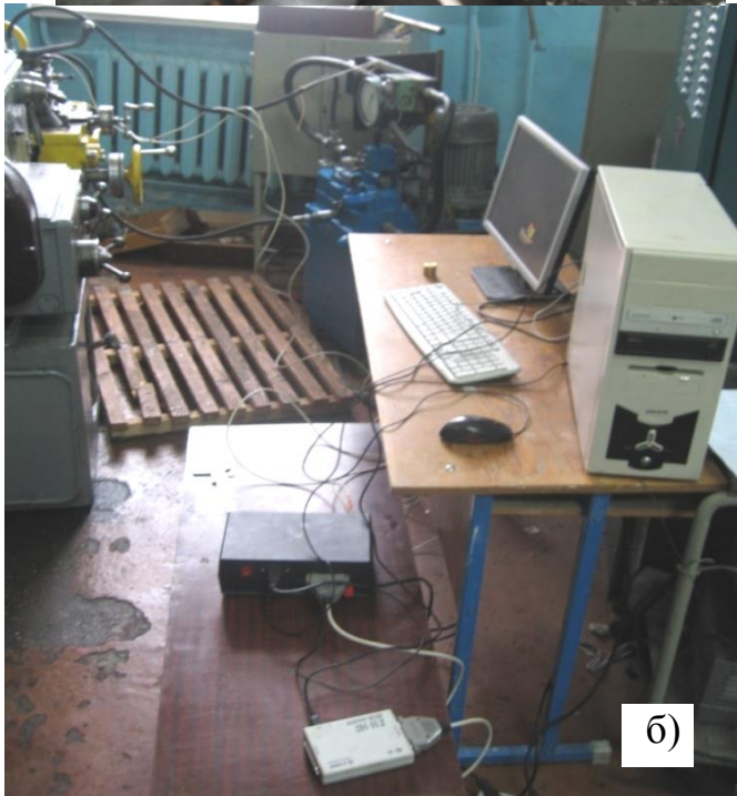
Рисунок 7 — Експериментальний стенд (б) для дослідження гідроімпульсного привода пристрою для радіального віброточіння з вбудованим ГІТ (а)
