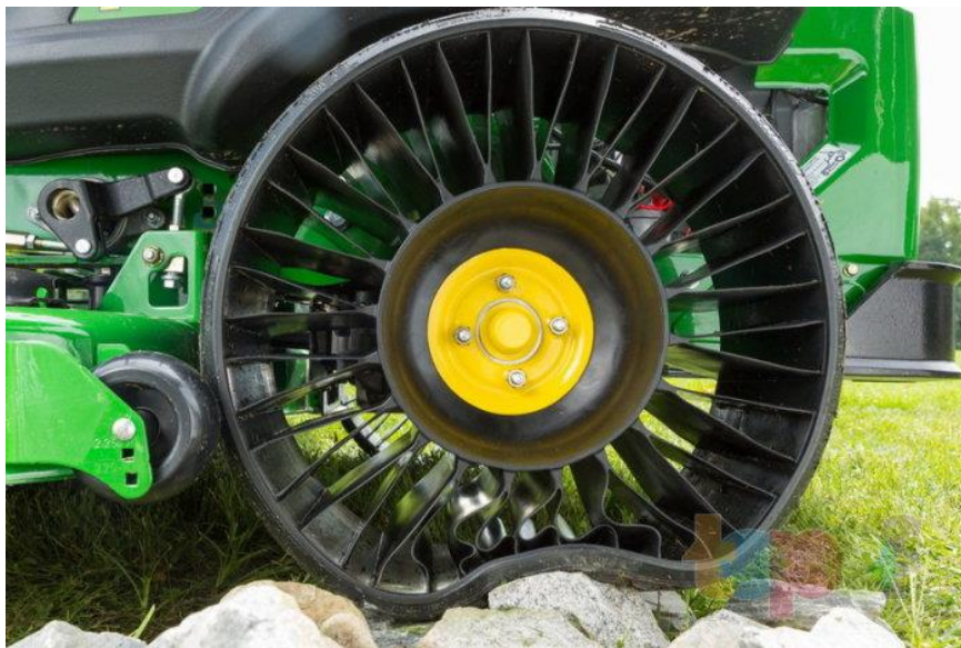
Рис. 3 – Загальний вигляд шин Tweel
