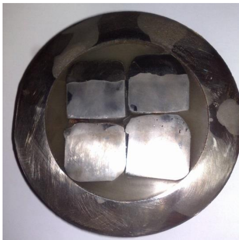
Рис. 1 – Макрошліфи зразків наплавленого металу: 1 – наплавлення електродом УОНИ 13/55
