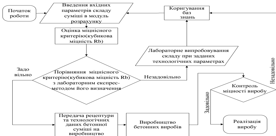
Рисунок 12 – Структурно-логічна схема технологічного процесу виробництва пресованих бетонних виробів з урахуванням впровадженого модуля інтелектуальної підтримки прийняття рішень при прогнозуванні міцності
