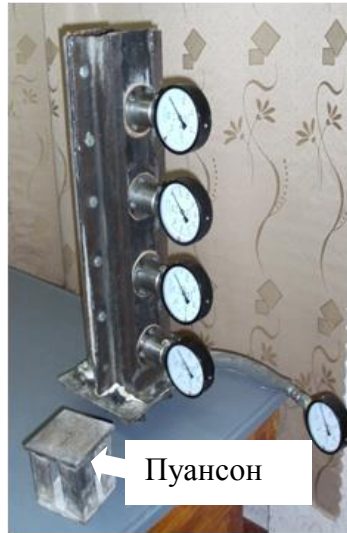
Рисунок 2 – Схема установки для вимірювання тиску в масиві бетонної суміші, що ущільнюється (зліва), та її фактична
