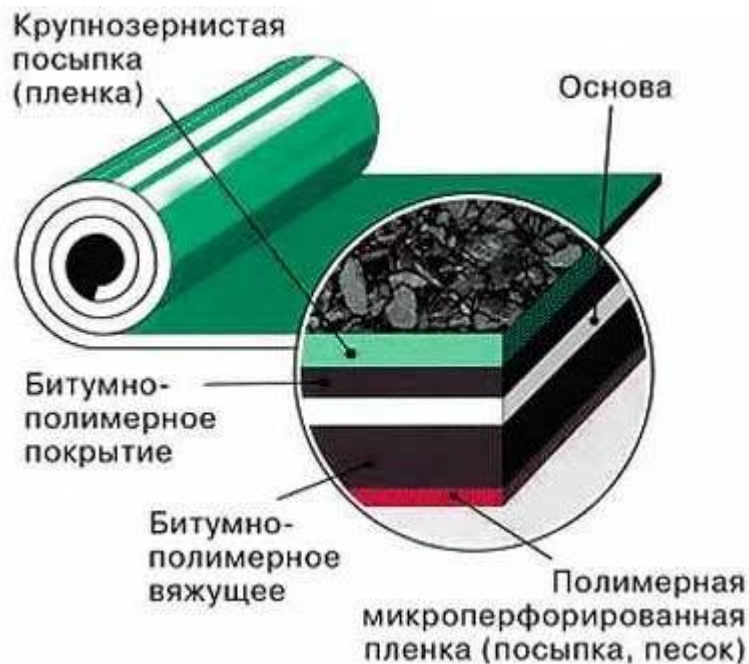
Рис.2 – Товщина і схема руберойду
