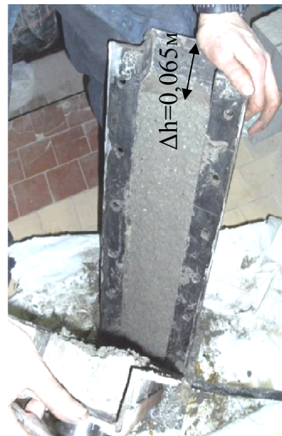
Рисунок 4.7 – Величина відносної деформації вібропресованого бетону після розпалублення форми
