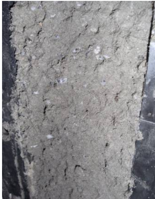
Рисунок 4.1 – Характер ущільненої структури спресованого бетону після розпалублення
