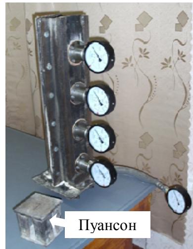
Рисунок 2.8 – Схема (а) та загальний вигляд установки (б) для вимірювання тиску в масиві бетонної суміші, що ущільнюється
