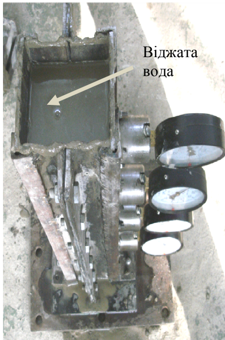
Рисунок 4.2 – Віджата вода ущільненої статичним пресуванням суміші
