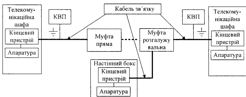
Рисунок 4.2 – Структура кабельної лінії зв'язку
