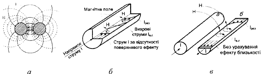
Рисунок 4.15 – Електричні процеси у крученій парі симетричних провідників: а – лінії електричного та магнітного поля; б – поверхневий ефект; в – ефект близькості
